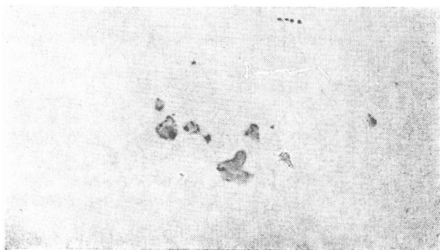
Рис. 7. Включения закиси марганца в литой стали ( \times 100 )
