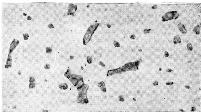
Рис. 16. Включения двойного сульфида \text{FeS} - \text{MnS} в литой стали ( \times 450 )
