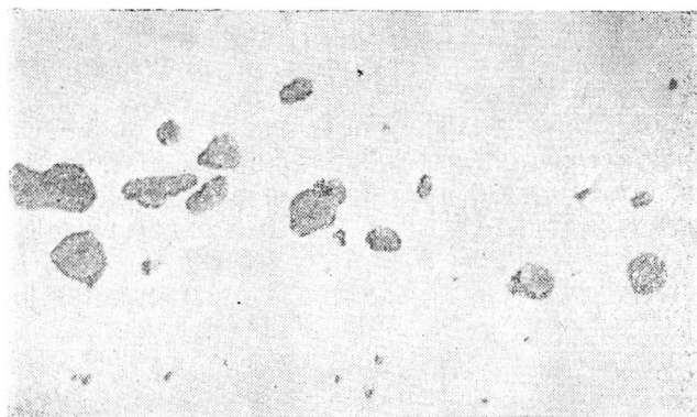
Рис. 8. Включения \text{FeO} - \text{MnO} в литой стали ( \times 450 )
